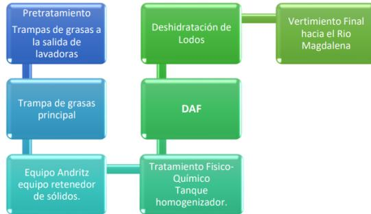
Imagen 4. Diagrama del proceso de tratamiento de las aguas residuales en Gelco S.A.S
